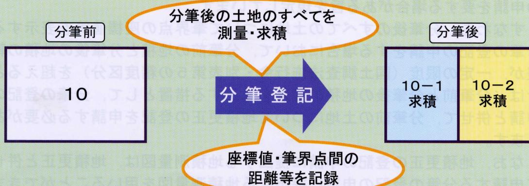
地積測量図は、土地の面積（地積）を表すとともに、土地を特定する重要な機能を有しており、正確な測量及び調査結果の成果に基づき作成するものです。
